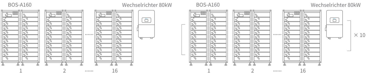
**Unterstützt max. 16 parallel geschaltete Batterieblöcke**
