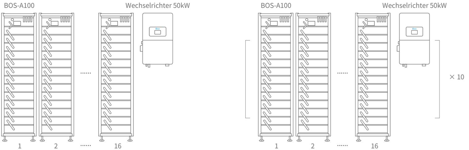
**Unterstützt max. 16 Batterie-Racks parallel**
