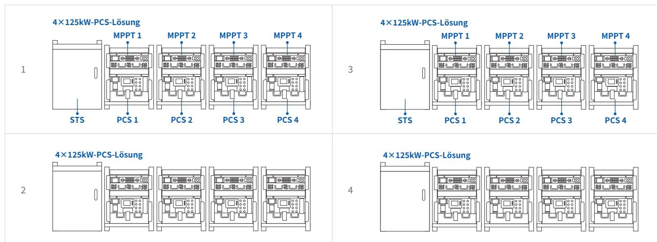
Fünf STS-Module können für zwanzig 125kW-PCS-Module parallele Unterstützung bieten und so ein 2,5MW-System bilden
