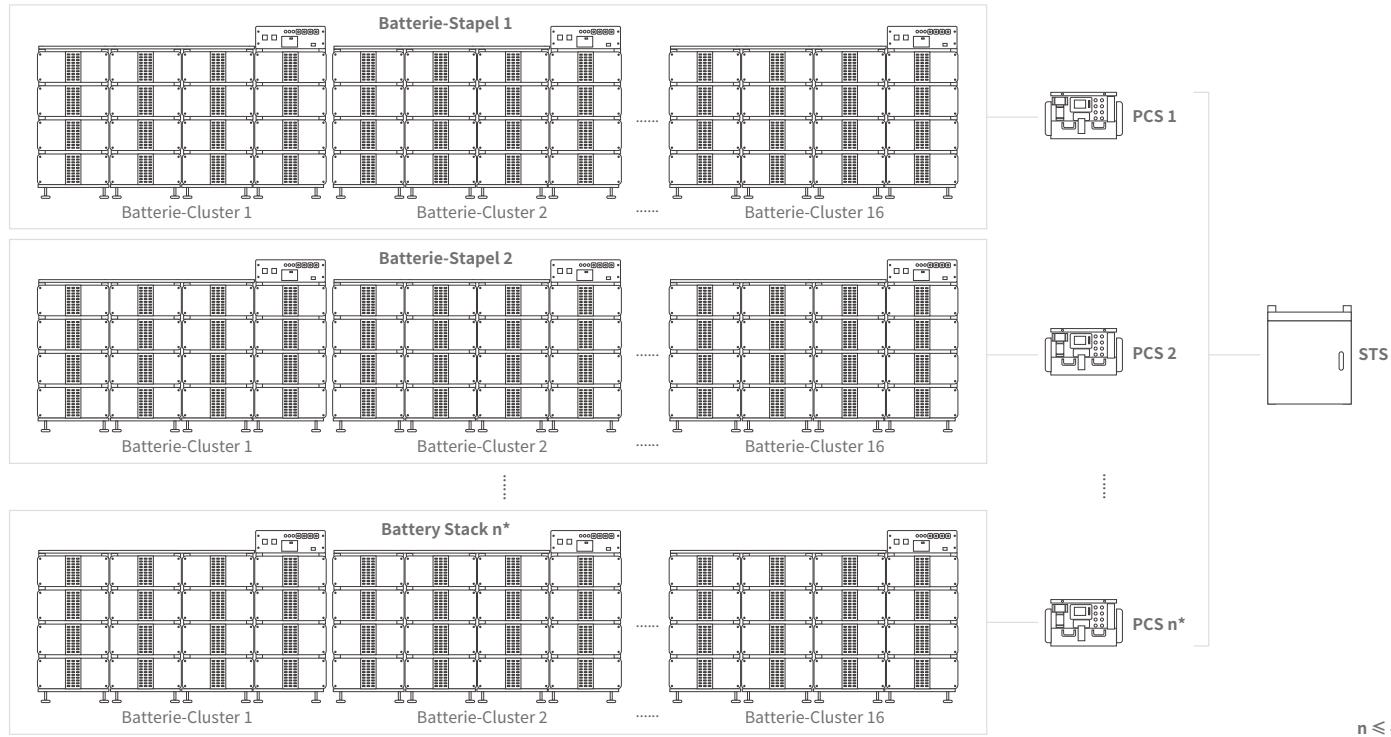
Ein STS-Modul kann sich mit vier 125kW-PCS-Modulen für den Parallelbetrieb verbinden
